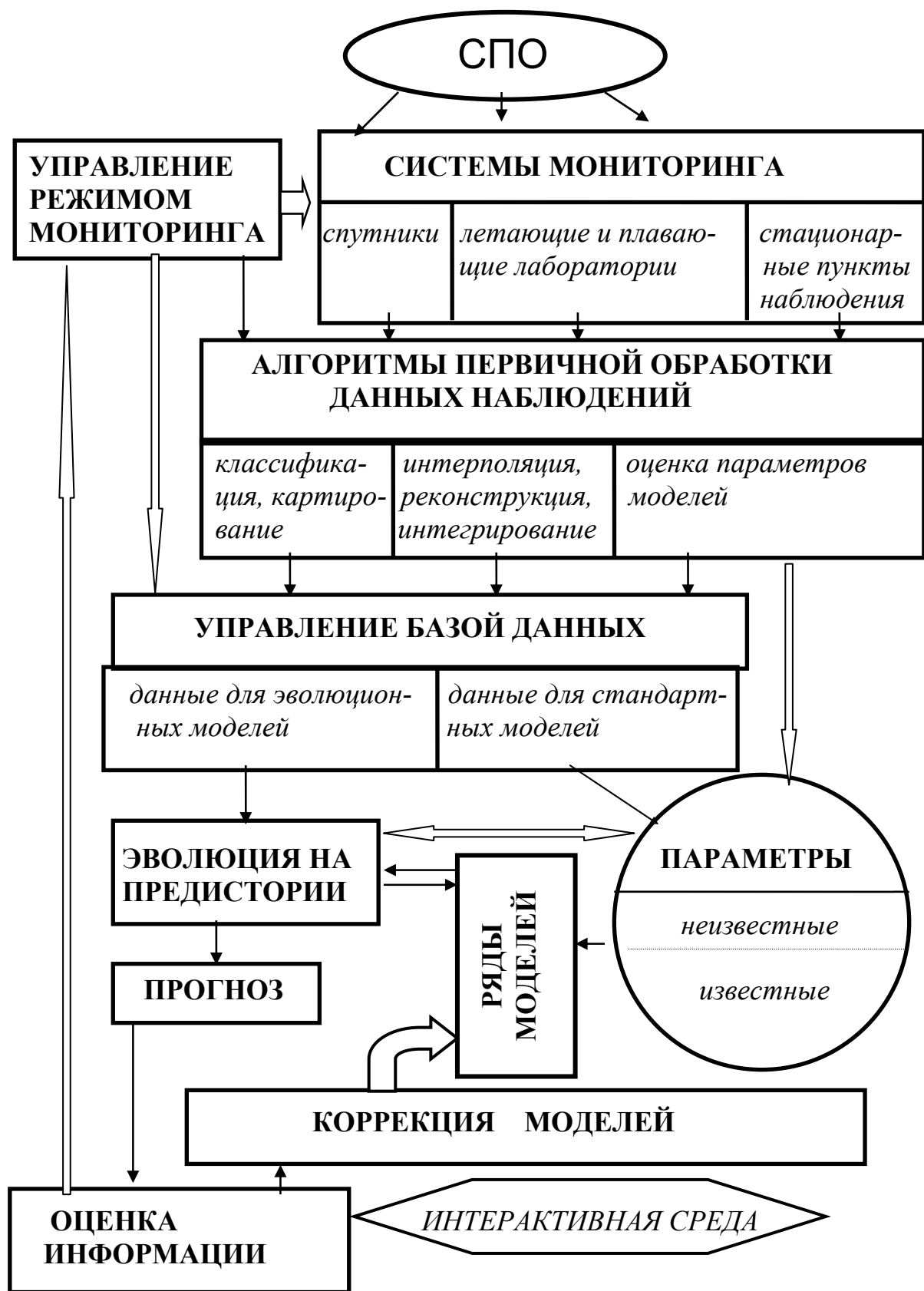
Рис.4. Концепция адаптивной настройки глобальной модели СПО в условиях геоинформационного мониторинга.
