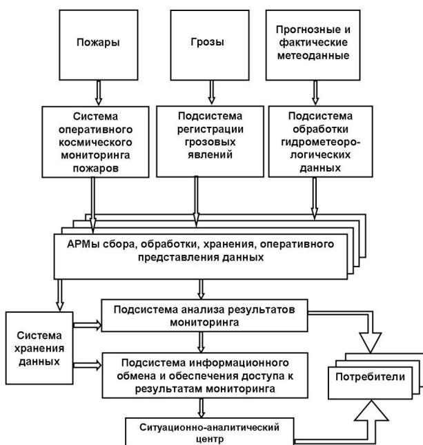
Рис. 1. Структурная схема проведения космического мониторинга природных пожаров
